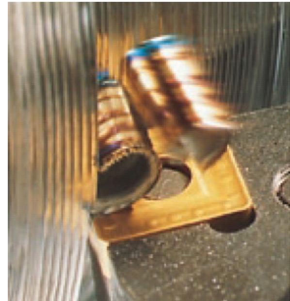
Le prove per determinare la lavorabilità devono necessariamente essere di tipo tecnologico: usura utensile (microscopia), forze di taglio (dinamometri), finitura superficiale (rugosimetri) determinati nelle condizioni di lavoro, per certi set di parametri tecnologici
